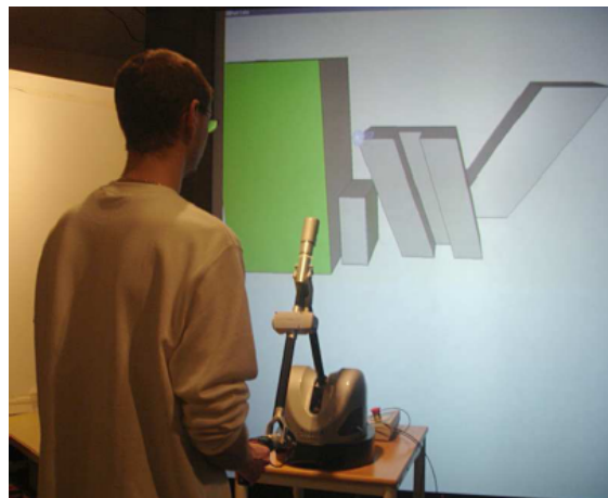
FIGURE 5.2 – Édition CAO à l'aide d'un périphérique haptique. Ici un utilisateur réalise une tâche d'extrusion, en étant guidé haptiquement selon l'axe de l'extrusion (Picon [128])
