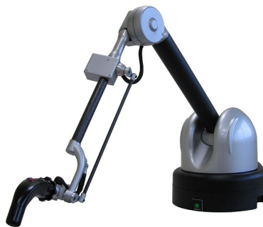
FIGURE 1.13 – Systèmes d'interaction à retour d'effort. Ici le Virtuose 6D de Haption, permettant des interactions et un retour d'effort à 6 degrés de liberté.
