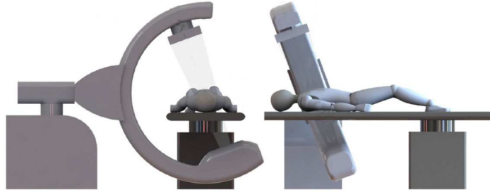
FIGURE 1.8 – Schéma d'un système d'acquisition mobile C-arm (image provient de medicalphysicsweb.org ).
