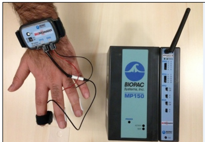
Figure 25. Boîtier Biopac MP150 et dispositifs de mesures EDA PPG
