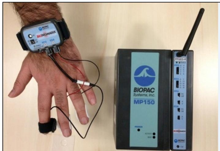
**Figure 25. Boîtier Biopac MP150 et dispositifs de mesures EDA PPG**
