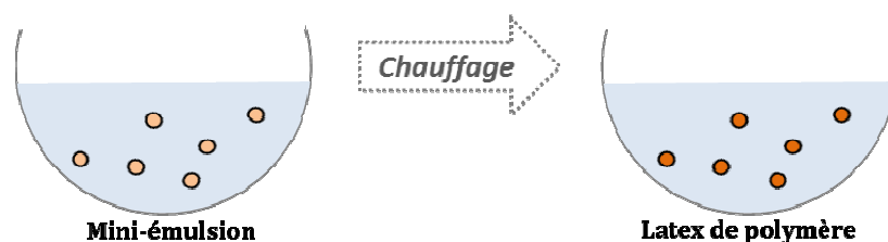
Figure I-21 : Polymérisation en mini-émulsion
