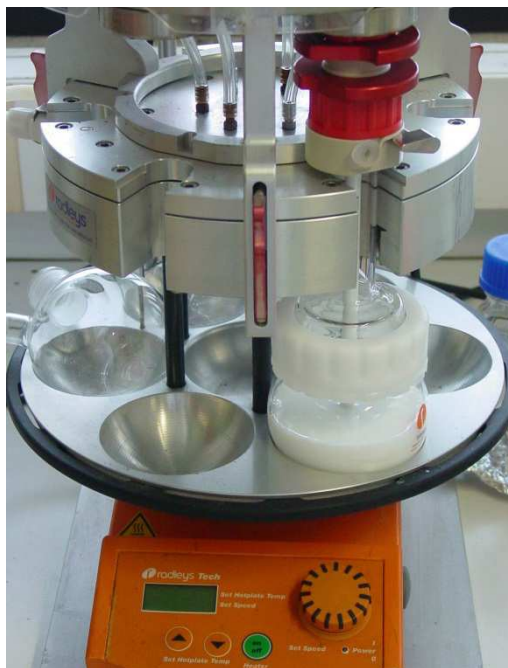
Figure V-3 : Carousel 6 Plus Reaction Station™ de Radleys utilisé pour la polymérisation en mini-émulsion
