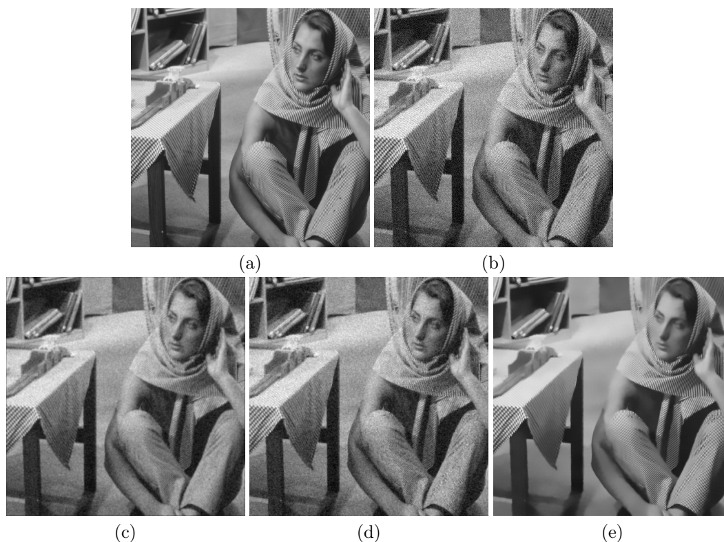
FIGURE 1.11 – Comparaison des résultats de débruitage d'une image bruitée (b), depuis une image initiale (a), par filtrage Gaussien (c), filtrage médian (d), et par moyennes non locales (Buades et al., 2005) (e). La méthode non locale permet un débruitage plus efficace, qui conserve notamment les textures.
