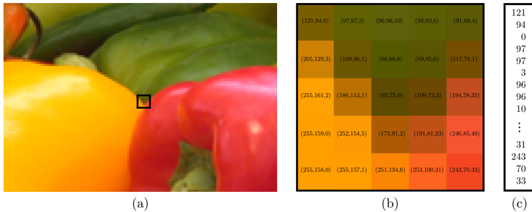
FIGURE 1.7 – Illustration d'un patch régulier. Un patch de taille 5 \times 5 pixels est extrait d'une image (a). Les valeurs de couleur des pixels (b), peuvent être résumées en un vecteur qui décrit le contenu du patch, dont un exemple est donné en (c).
