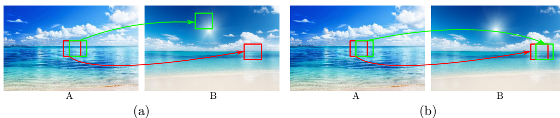
FIGURE 1.13 – Illustration du processus de propagation d'ANN de la méthode PatchMatch (Barnes et al., 2009). Deux patches adjacents dans l'image A sont initialisés aléatoirement (a). Le patch vert est dans une zone de bonne correspondance. Le patch rouge teste alors la zone accédée par son voisin adjacent, le menant à une meilleure correspondance (b).
