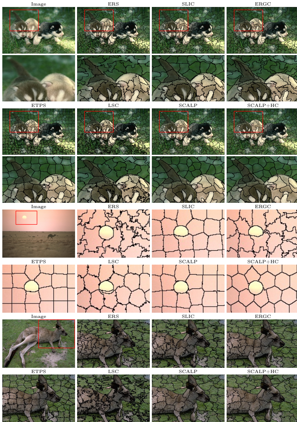
FIGURE 5.16 – Comparaison qualitative des décompositions de SCALP et des méthodes de l'état-de-l'art sur des images de la BSD. SCALP produit les résultats les plus satisfaisants, avec des superpixels réguliers qui adhèrent aux contours de l'image. SCALP+HC permet d'encore améliorer le respect des objets de l'image.
