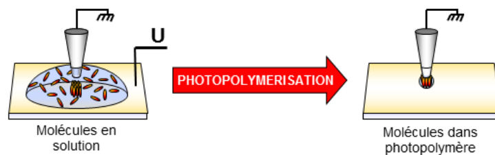
FIGURE 4.36: Fabrication d'une sonde auto-soutenue par photopolymérisation.
