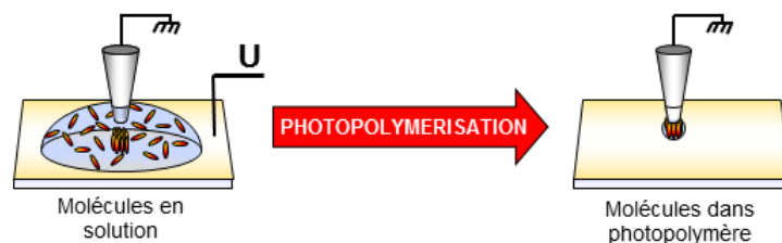
FIGURE 4.36: Fabrication d'une sonde auto-soutenue par photopolymérisation.
