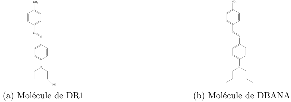
FIGURE 2.4: Molécules de DR1 et de DBANA : seul le groupement donneur d'électrons diffère.
