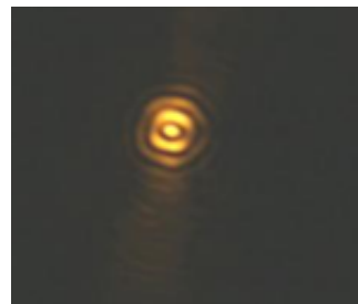
(b) Pointe laser alignée. La diffraction du laser par la pointe est superposée avec le spot correspondant à la focalisation du laser sur le substrat.
