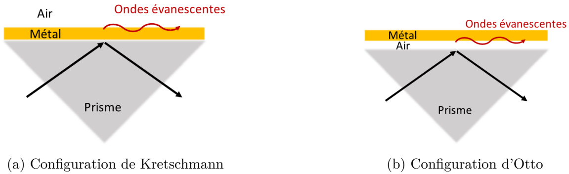
FIGURE 1.8: Génération d'ondes évanescentes avec un prisme
