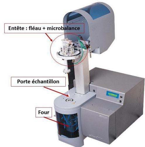
Figure II.2 : thermobalance SETARAM (E/SETEVO16-1F).
