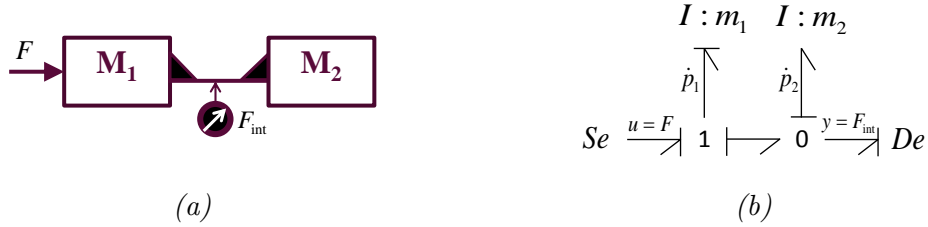
FIGURE 5.2 – Exemple de deux masses en liaison encastrement
