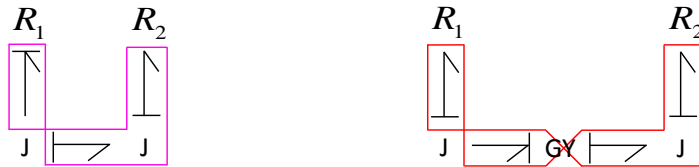
FIGURE A.2 – Boucle causale d'ordre 0 de classe 2 dans la classification de VAN DIJK [vD94]
