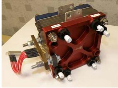
FIGURE 3.7: Stack cinq cellules BZ100 de UBzM
