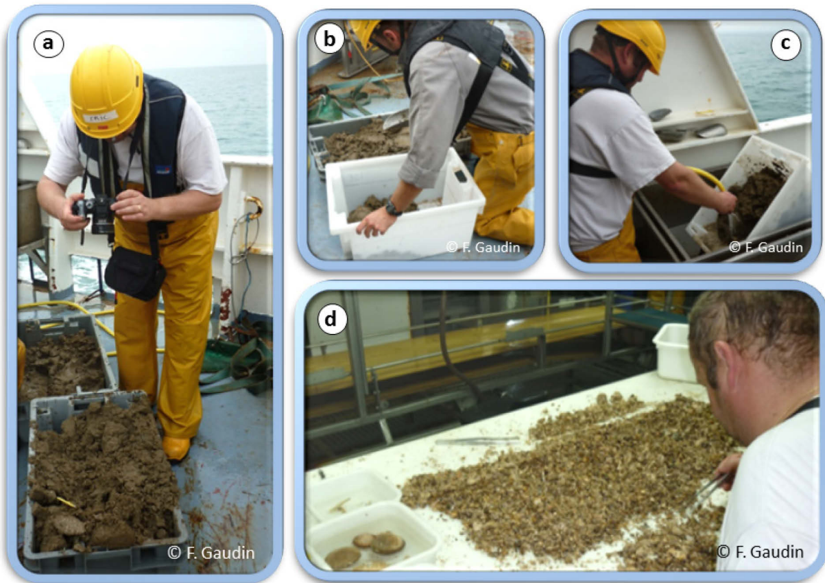
Figure 23. Etapes du traitement d'un échantillon : (a) photographie, (b) sous-échantillonnage à 30 L, (c) tamisage et (d) tri.
