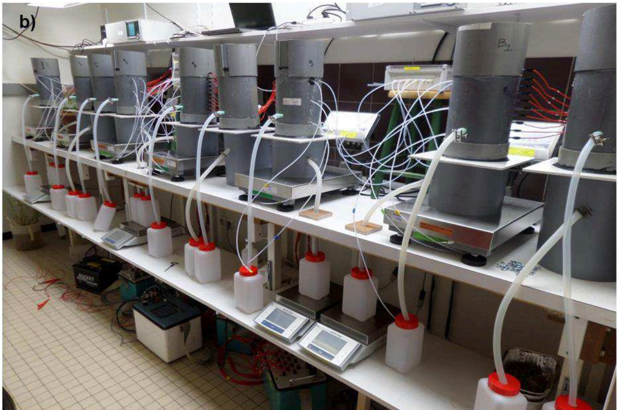
Figure 2.10 : Schéma d'une colonne équipée (a) et photographie du dispositif expérimental au laboratoire (b)
