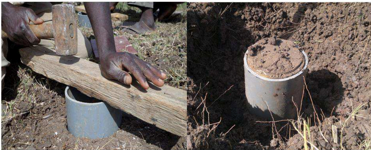
Figure 2.9 : Photographie du procédé de prélèvement des colonnes du sol in situ
