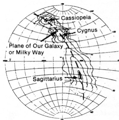
FIGURE 4.4 – Première carte du ciel en longueur d'onde radio réalisée par Reber en 1933 à 160 MHz (Source http://www.bigear.org/CSMO/HTML/CS13/cs13p14.htm ).
