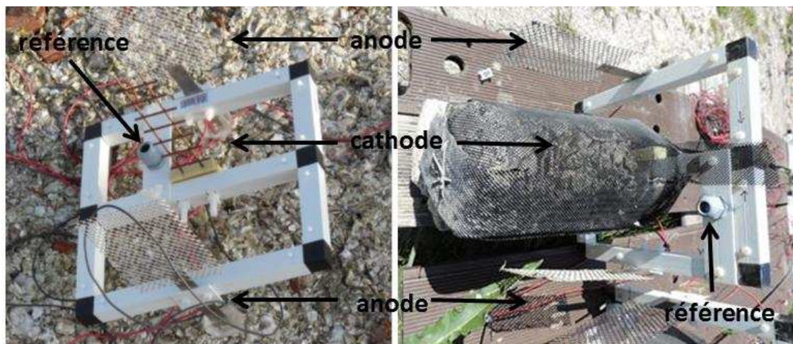
Figure 8 : Schéma du dispositif expérimental utilisé pour les expériences menées sur la plateforme d'Angoulins, avec ou sans manchon de sédiments
