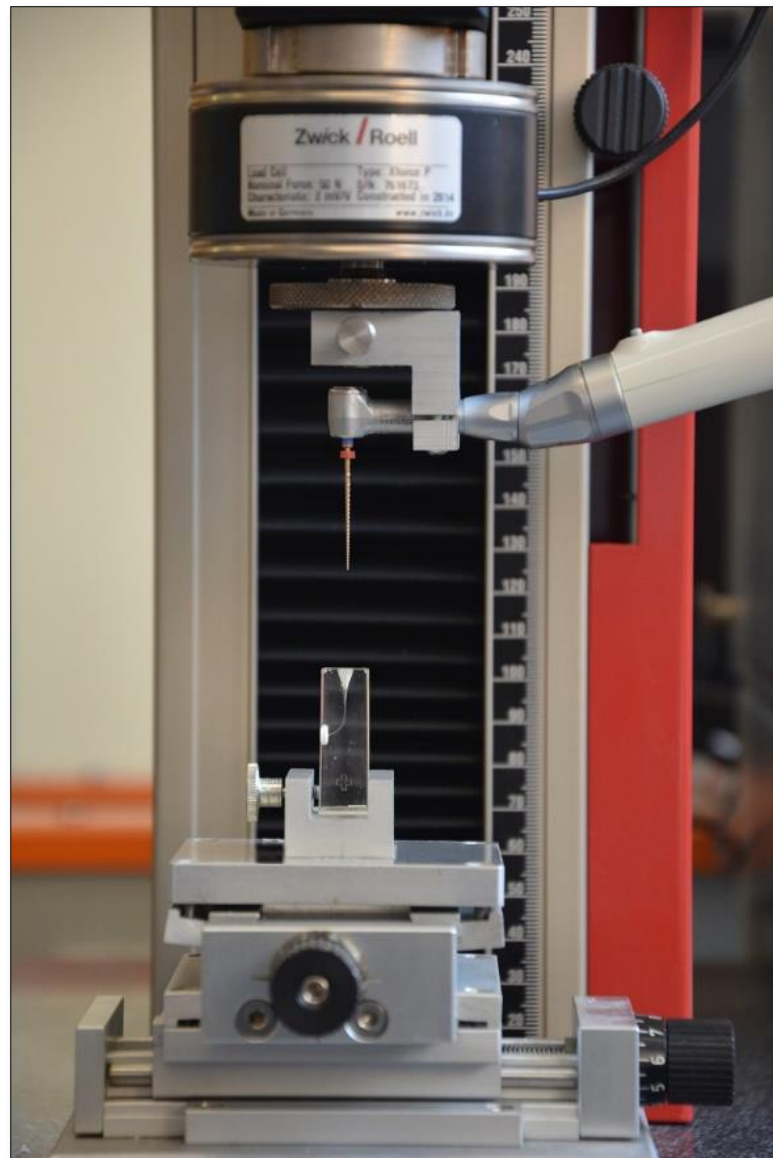
Figure 3.2. Photographie du banc d'essais servant aux manipulations en P/R et rotation continue.
