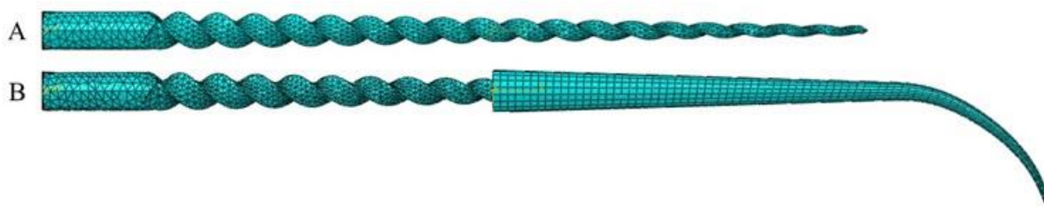
Figure 4.1. Maillages utilisés pour les instruments endodontiques (A) et les canaux radiculaires (B).
