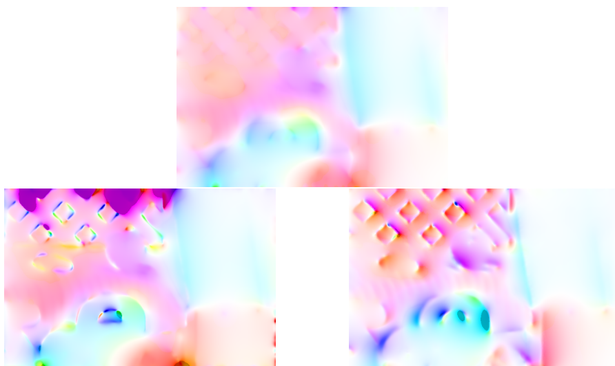
FIGURE 6.3 – Estimation du flot optique pour une séquence de larges déplacements avec, en haut, les résultats du schéma GDSI et en bas, les méthodes GDEx (gauche) et GDPD (droite).
