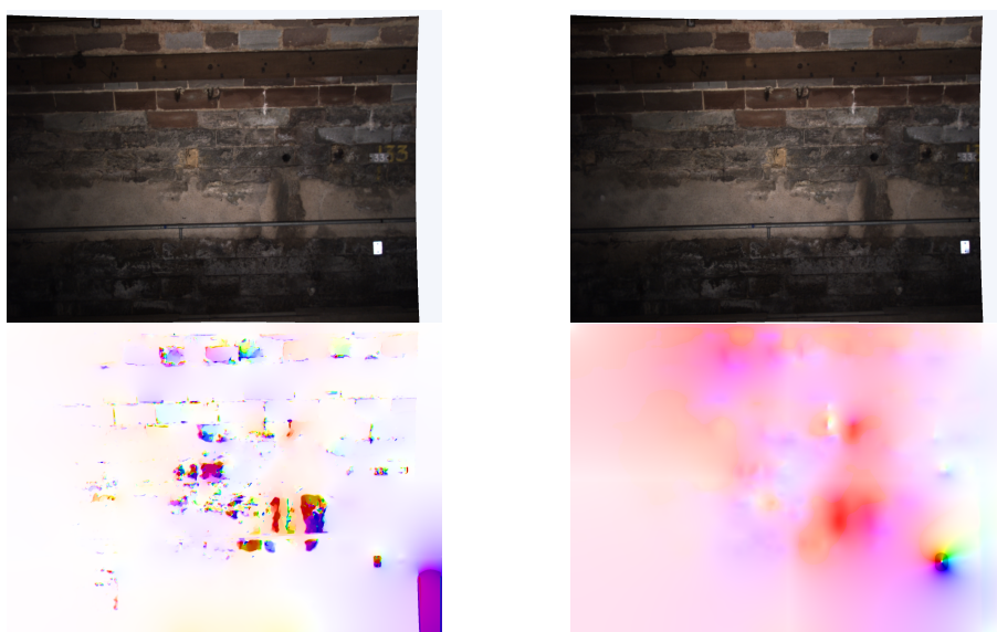
FIGURE 4.19 – Haut : cas test fourni par Cerema représentant le mur d'un tunnel. Bas : estimation du flot optique obtenue avec (droite) et sans (gauche) traitement de la luminosité. Décomposition en 16 sous-parties.
