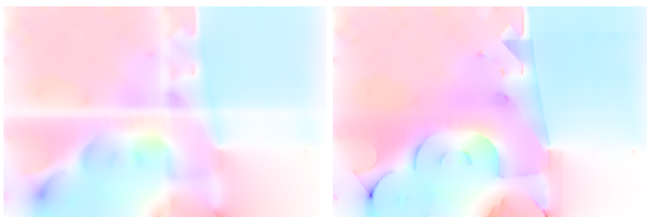
FIGURE 4.15 – Estimation du flot optique découpée en quatre sous-domaines. Gauche : Résultat obtenu sans la méthode de Schwartz. Droite : Résultat obtenu après cinq itérations de Schwartz.
