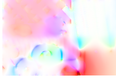
FIGURE 6.2 – Solution obtenue avec la méthode de décomposition de domaine pour les grands déplacements GD-DDM après 4 itérations de la méthode de Schwarz.
