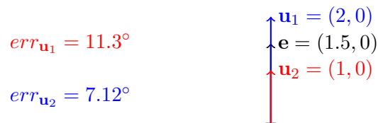
FIGURE 3.11 – Différence d'erreur angulaire pour deux vecteurs de même angle mais avec des normes différentes.
