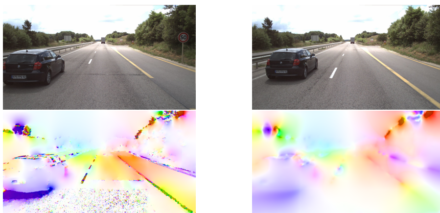
FIGURE 4.20 – Haut : cas test fourni par Cerema représentant des véhicules sur une autoroute. Bas : estimation du flot optique obtenue avec (droite) et sans (gauche) traitement de la luminosité. Décomposition en 16 sous-parties.
