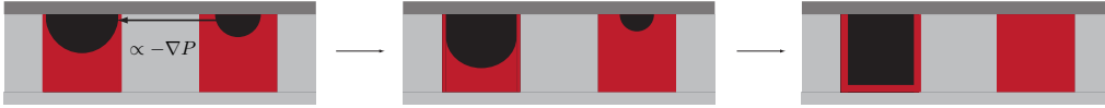
FIGURE 5.4 – Schéma du mécanisme de mûrissement. L'huile (représentée en noir) s'écoule depuis les régions de forte pression de Laplace. De manière équivalente, par conservation de la masse, les films fins d'eau (en rouge) se vident dans les films épais.
