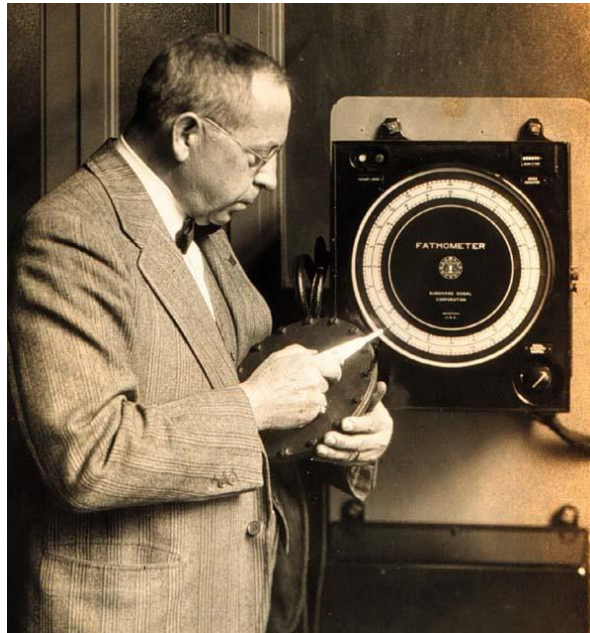
Figure 9 : Illustration du Fathometer, le premier sondeur, commercialisé en 1925 en Angleterre et aux États-Unis, destiné à mesurer la profondeur des océans. (NOAA Photo Library)
