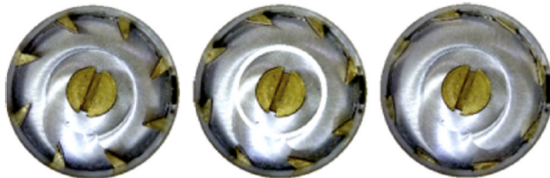
FIGURE 2.9 – Swirler radial à angle de pales variable. Trois positions sont représentées. Image reproduite de Durox et al. (2013)
