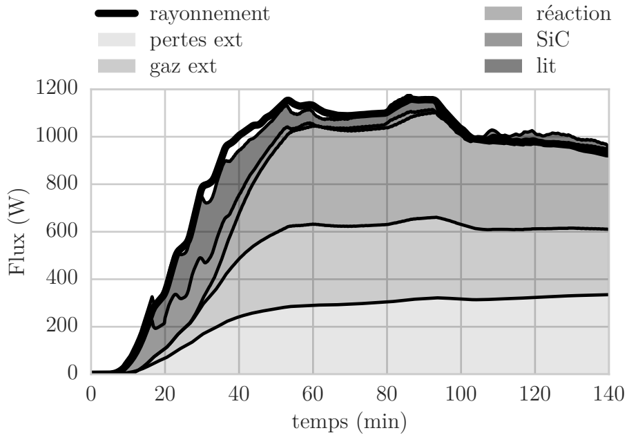
FIGURE 8.10 – Flux consommé dans la chambre de réaction au cours du temps. Rayonnement : le flux rayonné par la plaque émettrice. Perte ext : les pertes sur les parois du réacteur. gaz ext : l'énergie emportée par le gaz sous forme de chaleur. réaction : l'énergie consommée par les réactions chimiques. SiC : l'énergie nécessaire pour faire monter la phase SiC en température. lit : l'énergie nécessaire pour faire monter le lit en température
