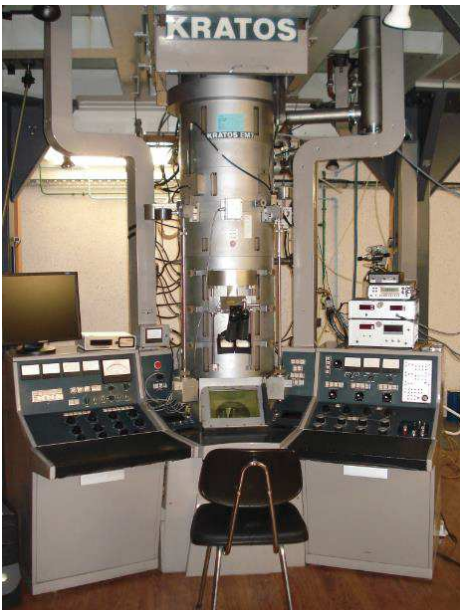
Figure D.1.1: Photos du Microscope Electronique à Très Haute Tension (THT) du SRMA.
