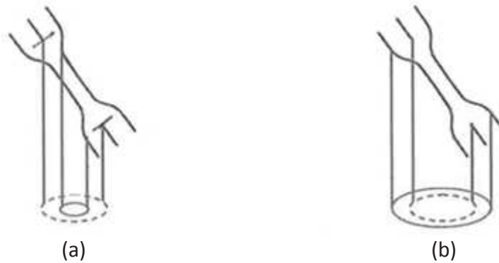
Figure D.2.3 – (a) Boucle lacunaire en contraste interne et (b) boucle lacunaire en contraste externe.
