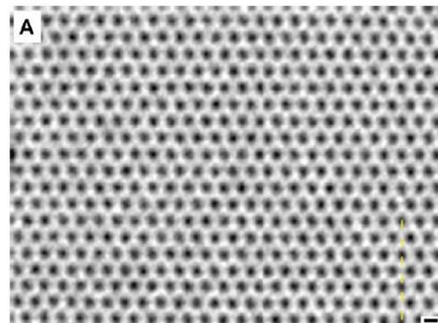
**Figure 39** : Cliché MET haute résolution d'un réseau d'atomes de carbone issu d'un feuillet de graphène.<sup>183</sup>
