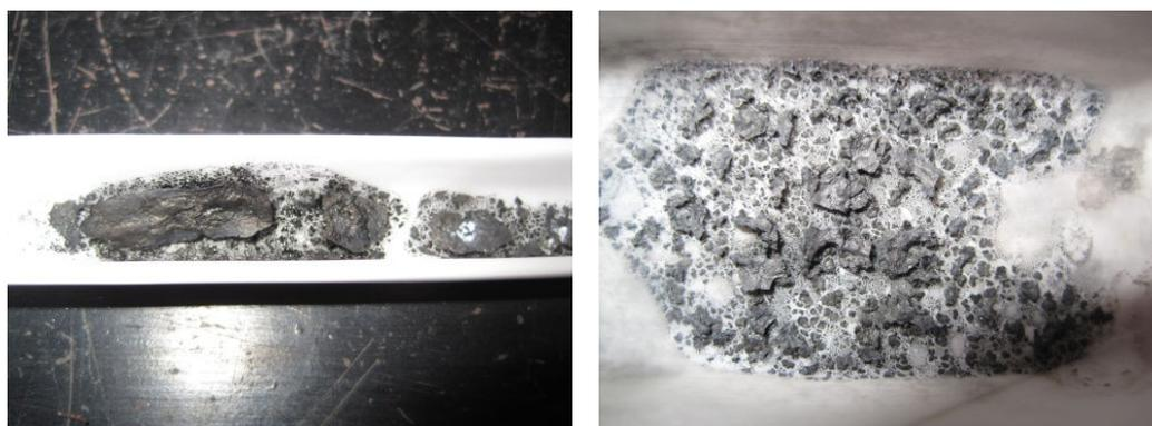
**Figure 89** : Photos de matériau carboné issu de la pyrolyse à 900 °C des aérogels de chitosane imprégnés de [EMIm][dca].
