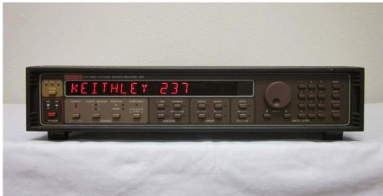
Figure 6 : Appareillage de mesure électrique Keithley 237
