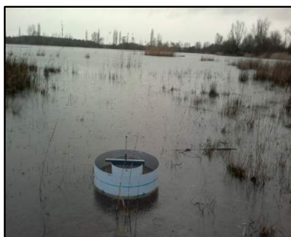
Photo 17 : L'infiltromètre à double anneau. Cliché : M. Aldomany, 2014.
