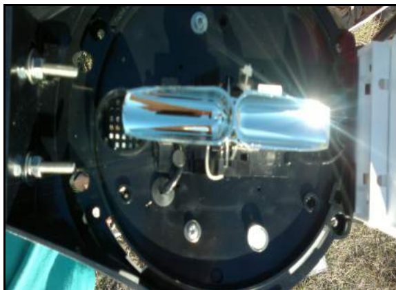
Photo 6. Les deux augets du pluviomètre. Cliché : M. Aldomany 2013.
