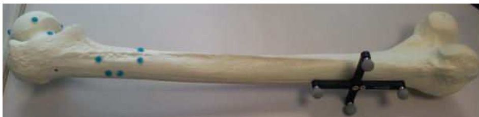
Fig.15 Fémur sawbone avec les marqueurs (billes bleues) collés sur sa surface et un traqueur
