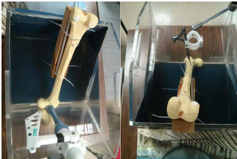
Fig.8 Acquisitions échographique sur le fémur sawbone et numérisation des marqueurs
