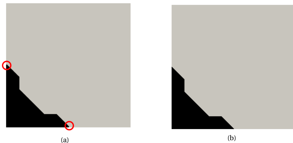
Figure A.1 – (a) Défaut de placement à l'échelle micrométrique (b) Placement à l'échelle unitaire
