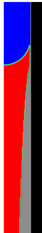
Figure 3.37 – Simulation d'une montée capillaire dans un canal de section variable par modèle diffusif
