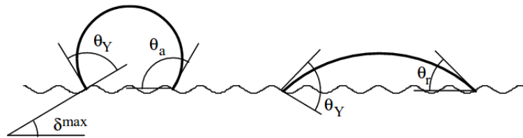
Figure 1.16 – Représentation schématique de l'effet de rugosité sur l'angle de contact apparent (d'après [116])
