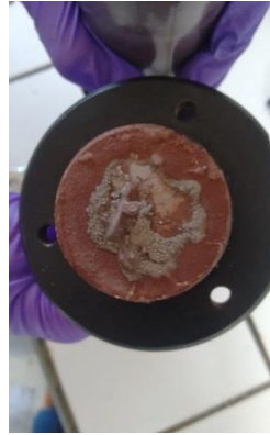
Figure 4.21 – Obstruction du media filtrant lors de l'injection de la solution de nitrate d'argent
