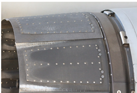
(a) Volets de tuyère en C/SiC du moteur M88 monté sur Rafale
