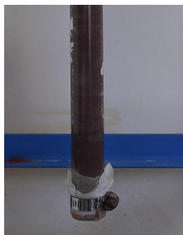
Figure 4.38 – Vue du dépôt d'argent formé au sein du milieu n°4 en fin d'imprégnation
