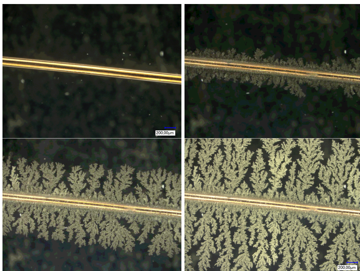
Figure 4.15 – Formation d'un arbre de Diane le long d'un fil de cuivre
