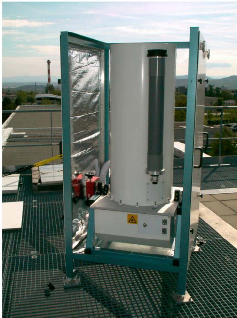
Figure 2.6: Partie optique du LIDAR de Clermont Ferrand situé sur le toit du Laboratoire du campus universitaire des Cézeaux. Dans le boîtier du système optique, NS signifie neutral density filter, BS beam splitter, PBS polarization beam splitter et IF interference filter.
