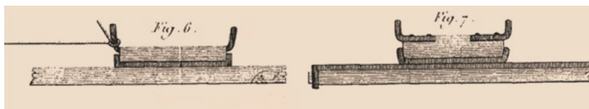
Figure 1.23 – Expérience de Coulomb sur le frottement.
