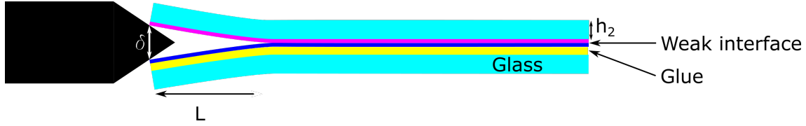
Figure 1.15 – Schéma d'un essai de clivage.
