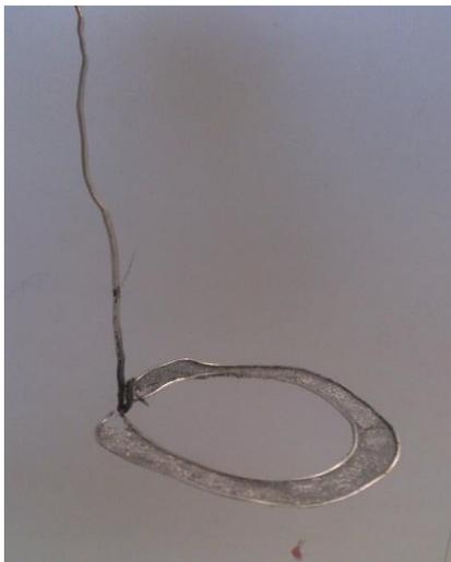
*Figure III-3 : Image de l'électrode de platine utilisée dans le réacteur sonochimique.*
