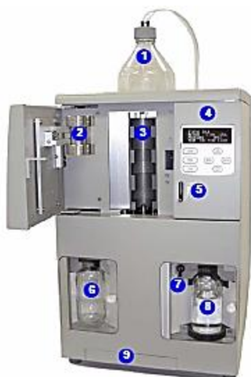
Figure 31 : L'extracteur ASE 150 ® et ses principaux composants.
