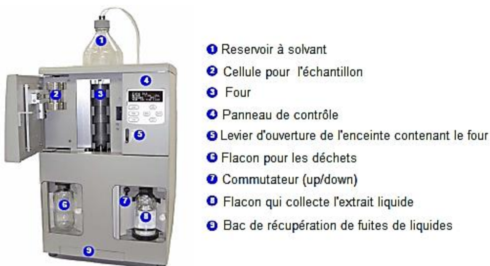
Figure 31 : L'extracteur ASE 150 ® et ses principaux composants.
