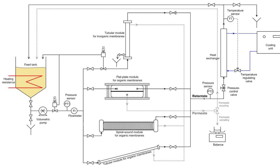
Figure I- 11 : Schéma du pilote expérimental de filtration.
