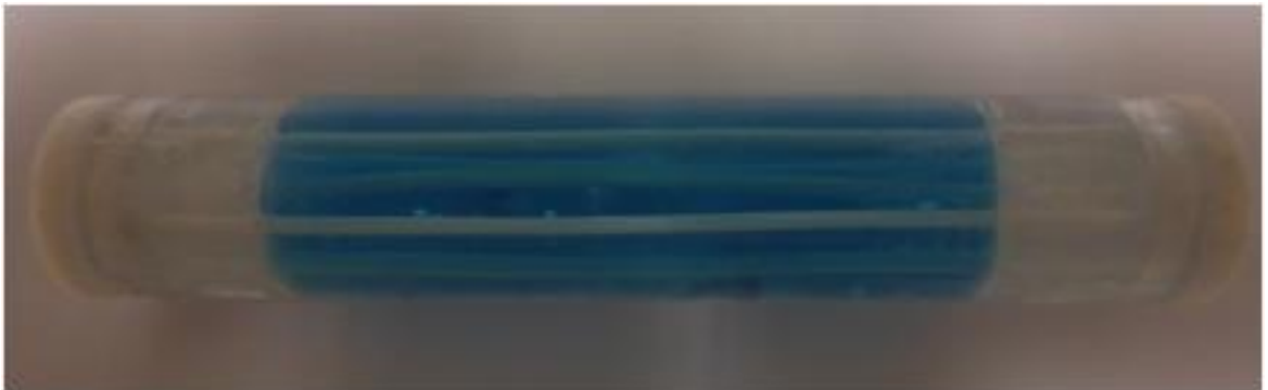
Figure III- 8 : Photographie montrant le tube avec les fibres enrobées dans le gel.
