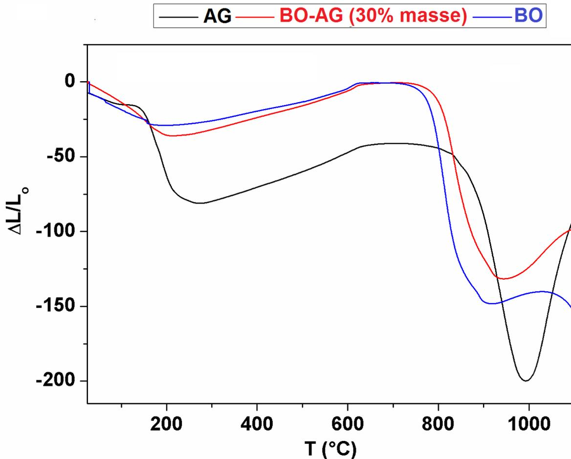
*Figure III-9 : Courbes d'analyse dilatométrique d'échantillons étudiés.*
