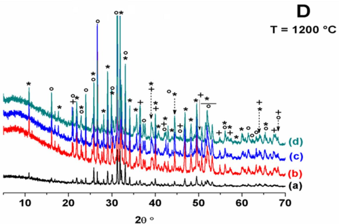
**Figure II-2 :** Diffractogrammes des rayons X d'agrégats cuits à 1100 (C) et 1200°C (D).
