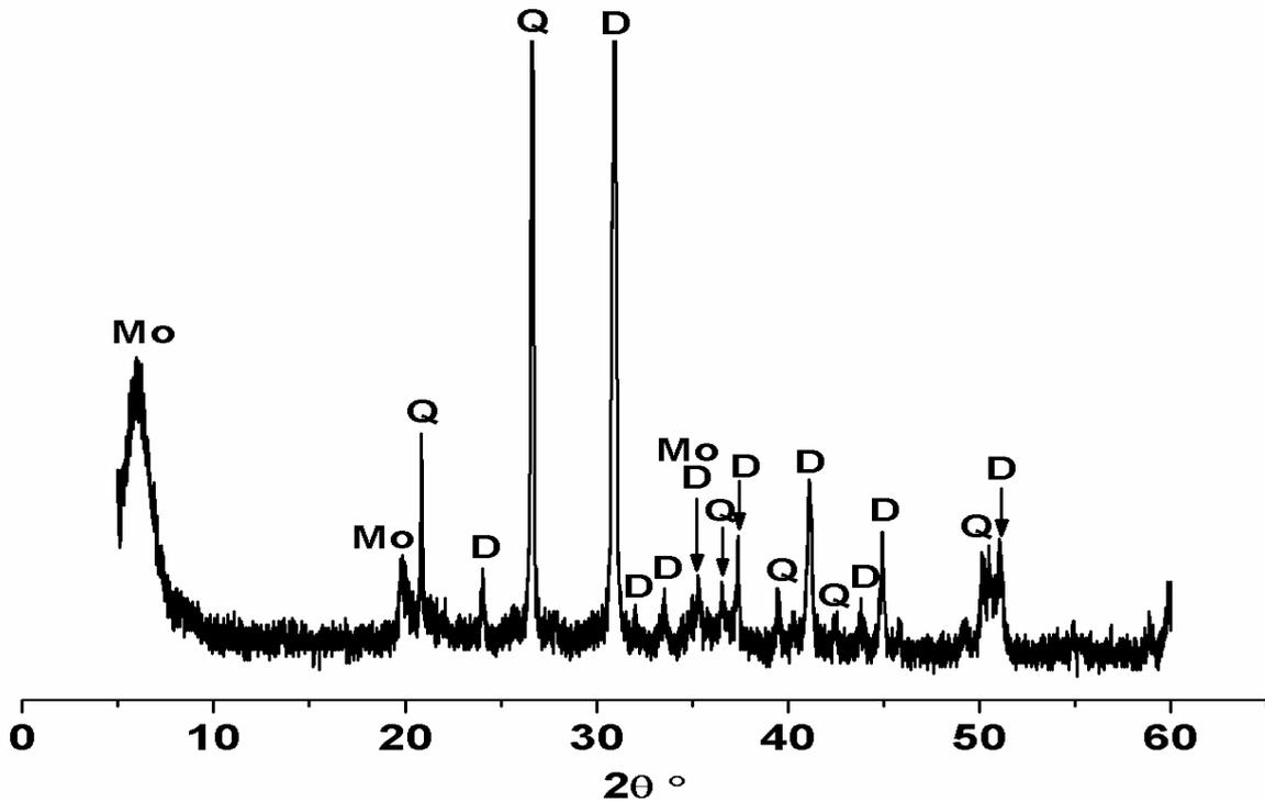
Figure I-4 : Diffractogrammes des rayons X de AG.
