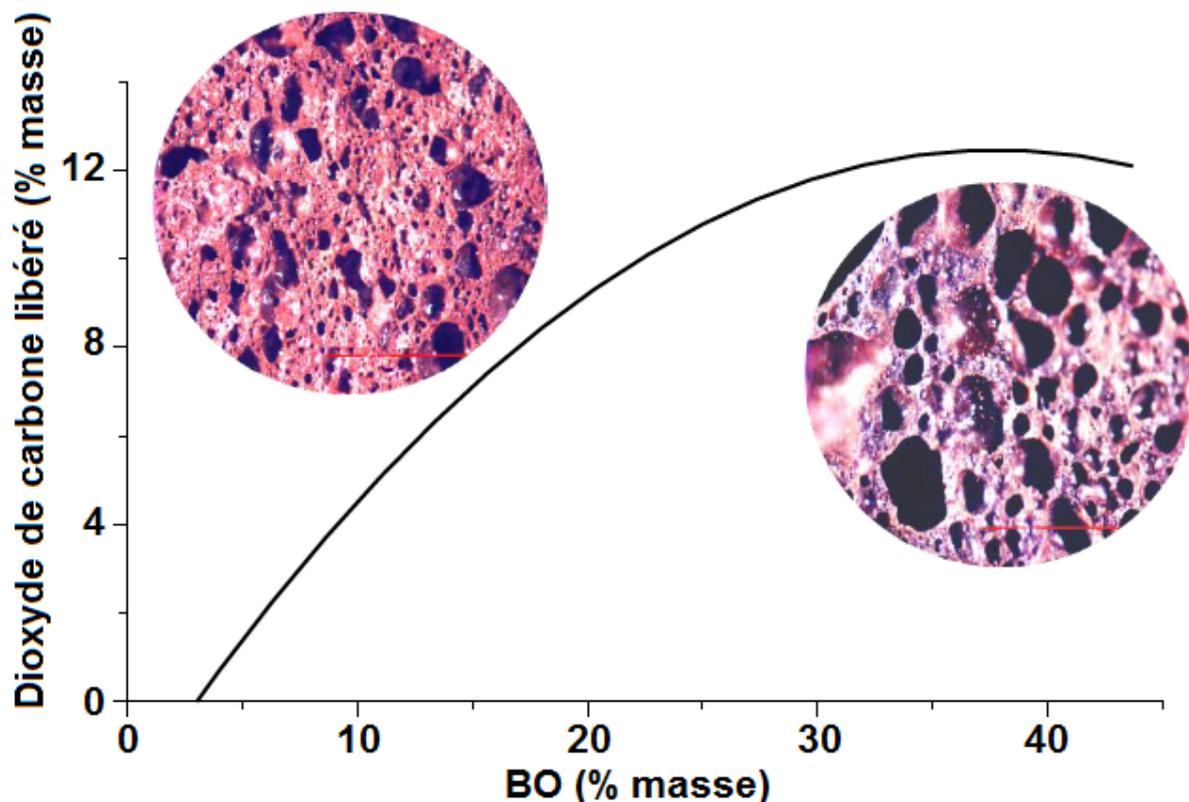
*Figure III-3 : Evolution de la quantité de dioxyde de carbone susceptible d'être libéré à 1100°C en fonction de la teneur en BO. Les micrographies montrent la microstructure des agrégats chauffés renfermant des teneurs faibles et élevées de BO.*
