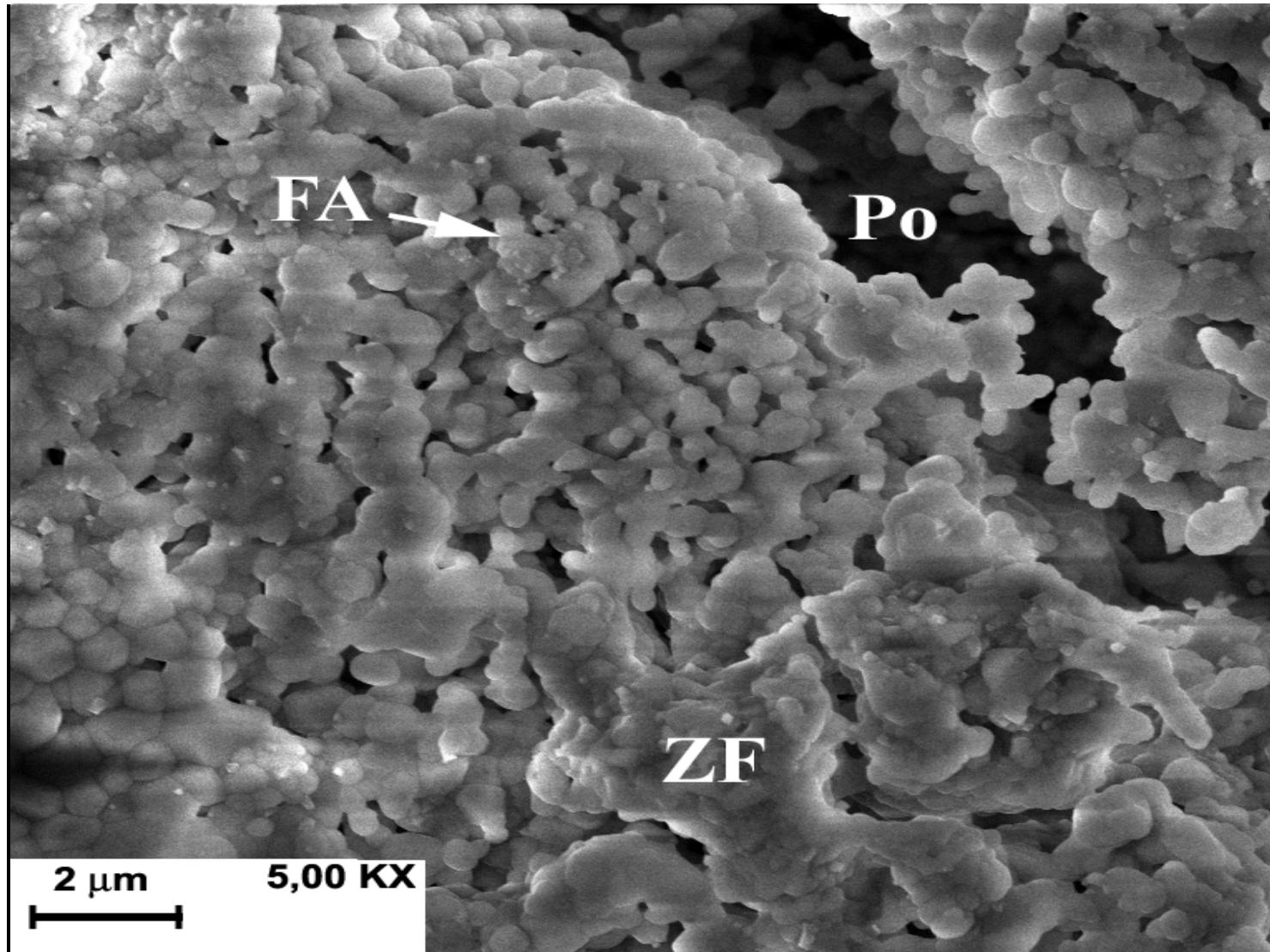
*Figure II-5 : Micrographie de MEB de BO chauffé à 1200°C.
