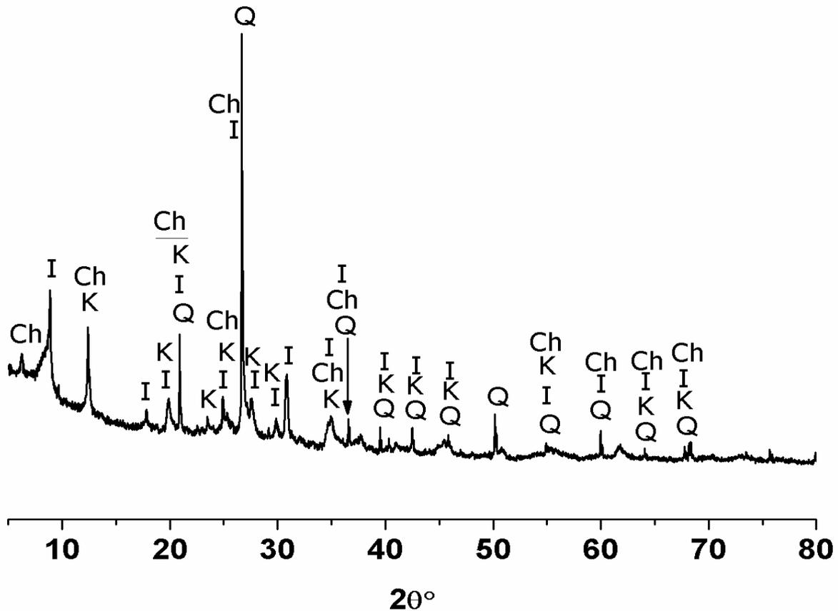
Figure I-5 : Diffractogrammes des rayons X de AK.
