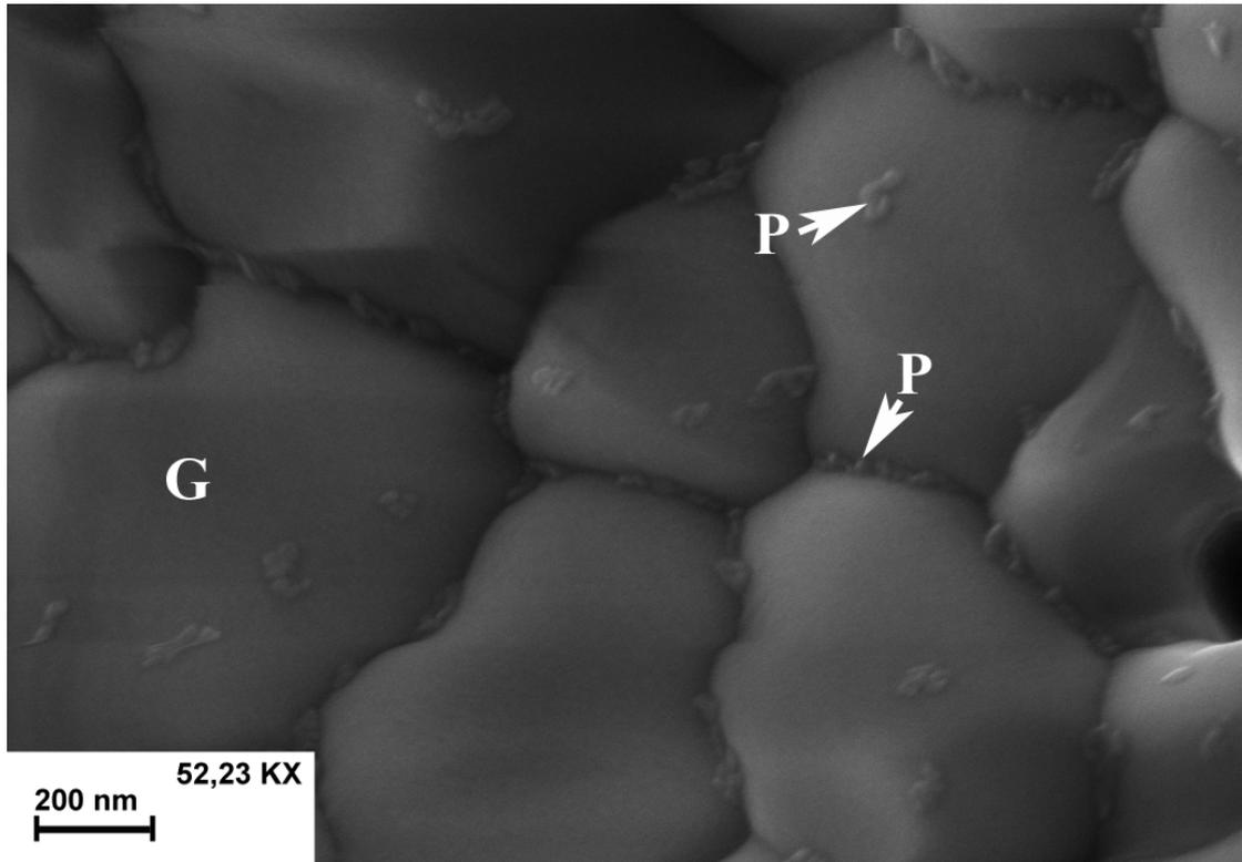
*Figure II-7 : Micrographie de MEB de BO chauffé à 1200°C.
