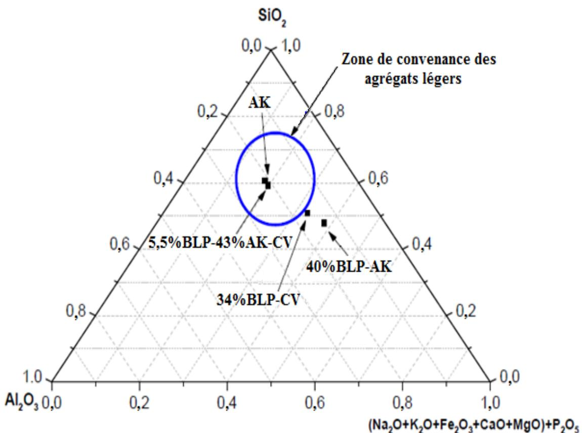
**Figure IV-1 :** Diagramme de Riley (1951) montrant compositions chimiques appropriées pour les agrégats conventionnels. Les points représentent les mélanges étudiés : AK : Argile Kaolinitique ; CV : Cendre volant ; BO : Boue de lavage des phosphates.
