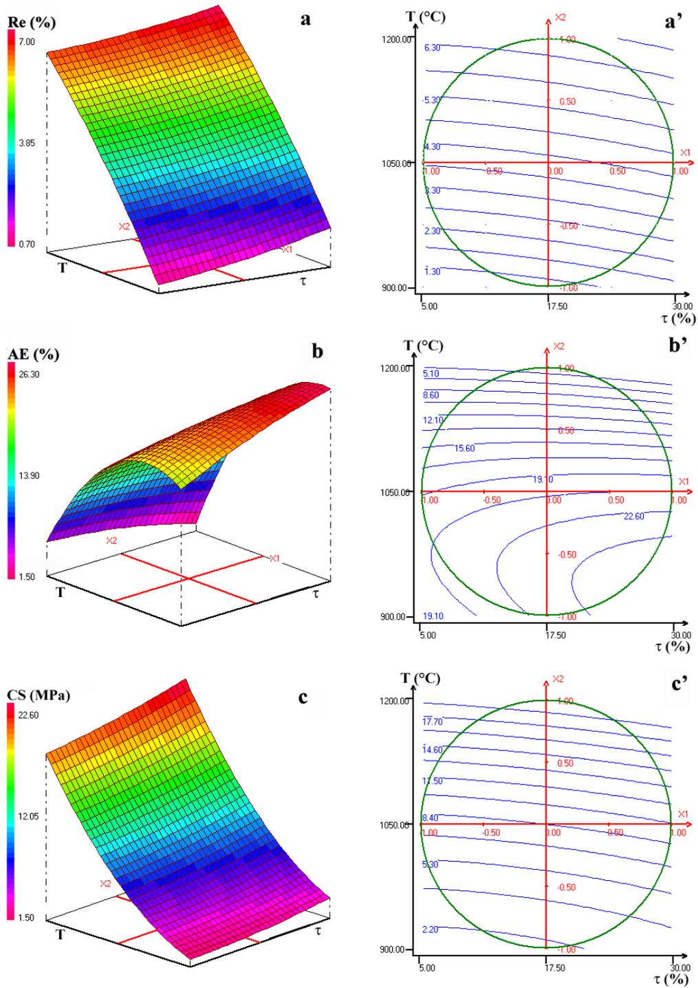
**Figure III-5 :** Evolution de la résistance à la compression (a, a'), de l'absorption d'eau (b, b') et du retrait à la cuisson (c, c') des mélanges de BO-30%AG en fonction de la température et la teneur en argile.
