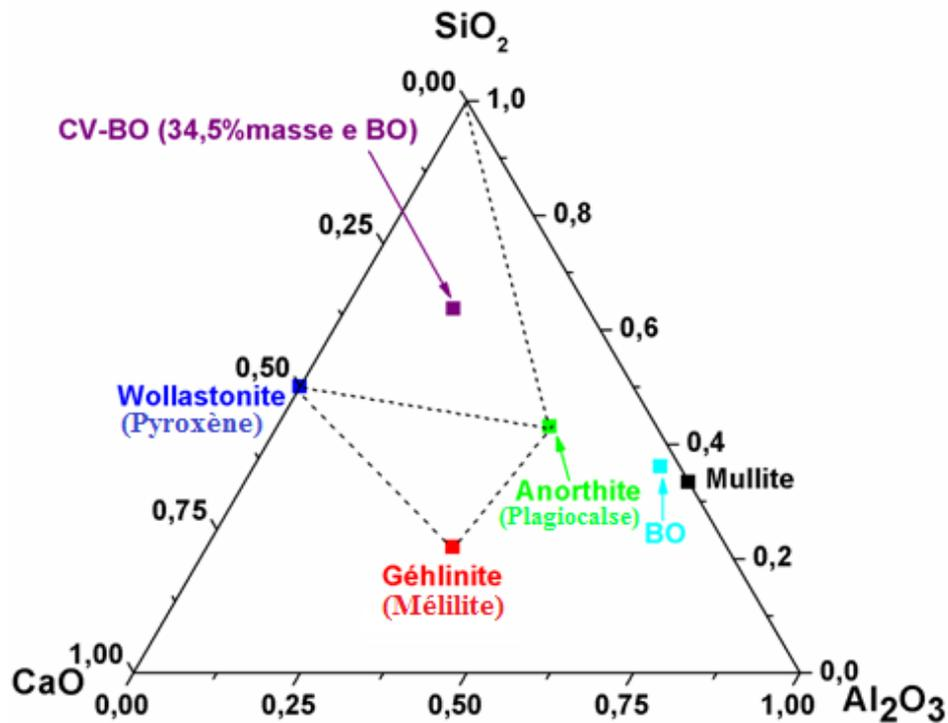
*Figure II-26 : Diagramme de phases CaO-SiO<sub>2</sub>-Al<sub>2</sub>O<sub>3</sub> montrant les points représentatifs des échantillons étudiés dans le cas du mélange 65,5%CV-BO.*
