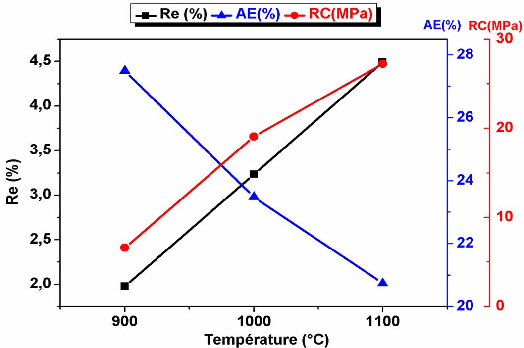
*Figure II-27 : Evolution des propriétés technologiques des agrégats de mélange CV-BO (65,5 % en masse de CV) en fonction de la température de cuisson. Avec **Re** : Retrait à la cuisson ; **AE** : Absorption d'eau et **RC** : Résistance à la compression.*
