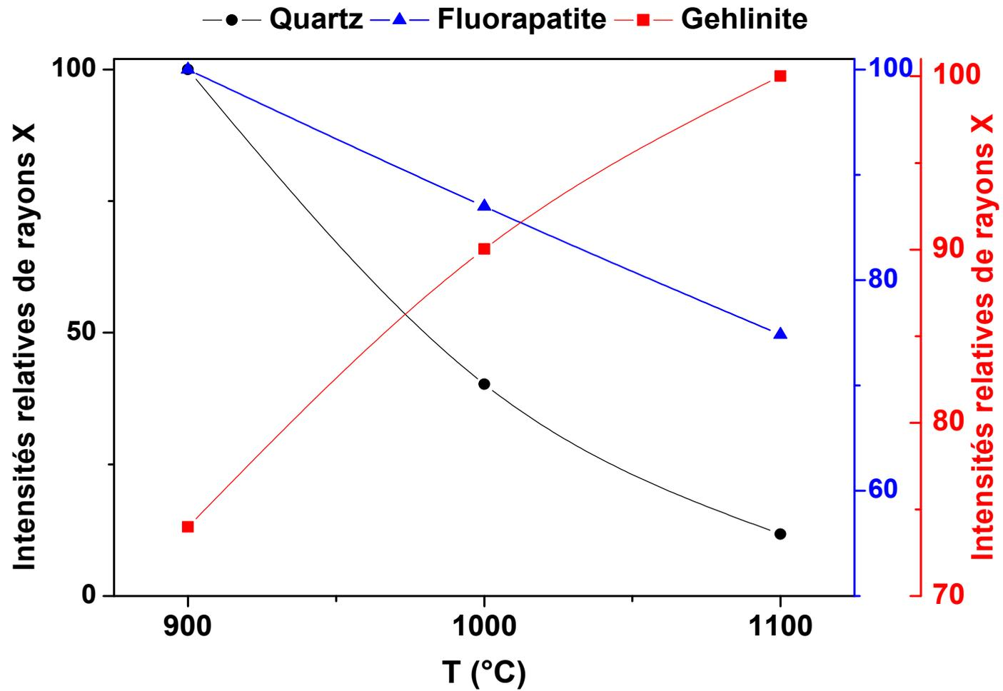
Figure III-11 : Intensités relatives des principales réflexions des rayons X de quartz, de fluorapatite et de la gehlénite.
