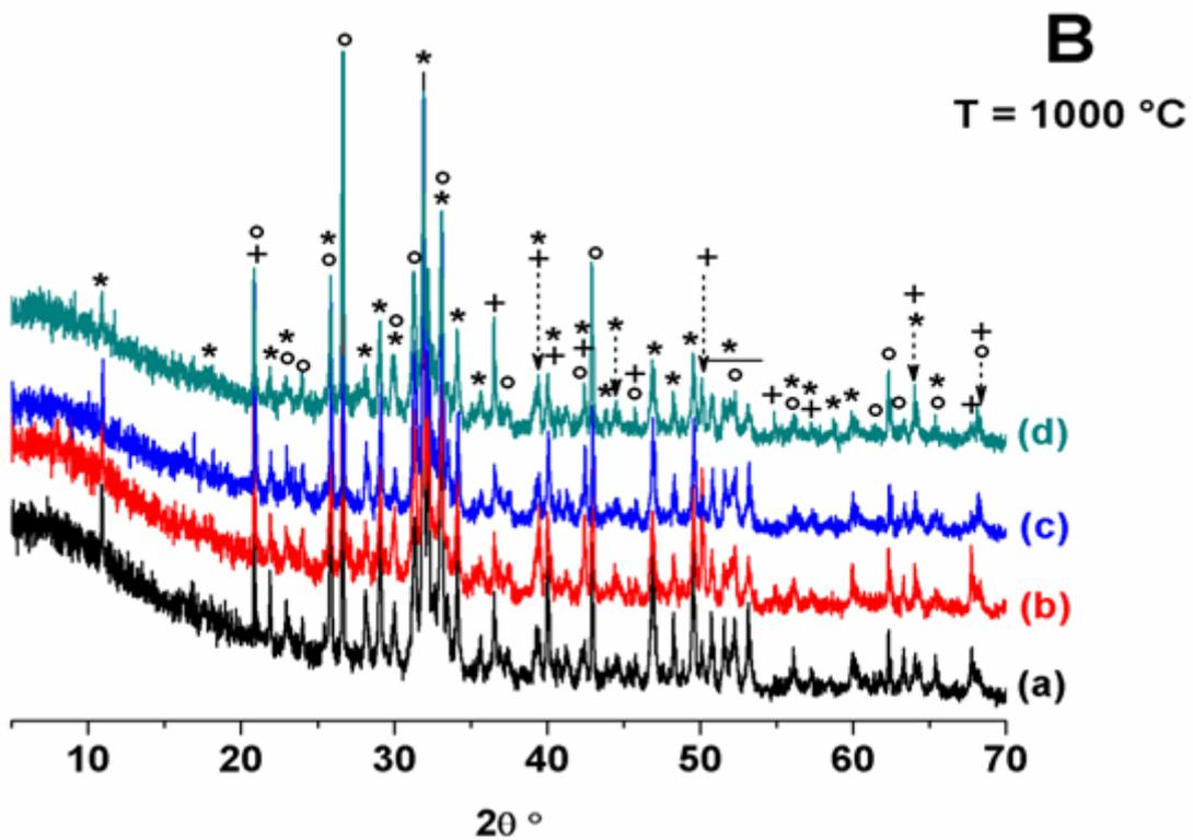
**Figure II-1** : Diffractogrammes des rayons X d'agrégats cuits à 900 (A) et 1000°C (B).
