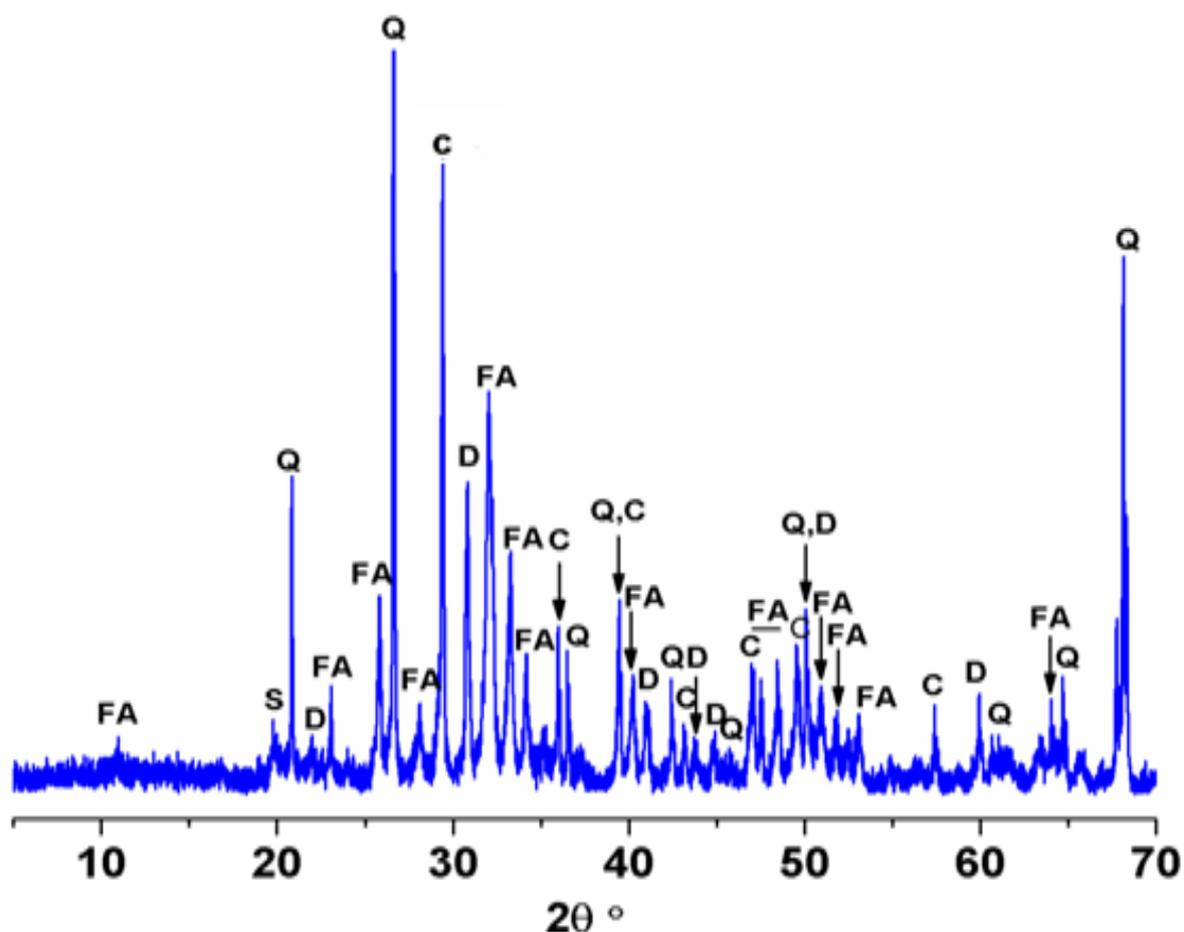
**Figure I-2 :** Diffractogrammes des rayons X de BO.
