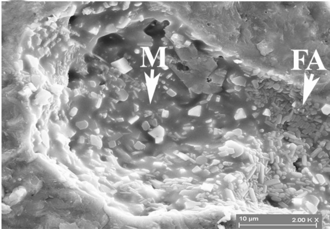
*Figure II-16 : Micrographie de MEB montrant la microstructure typique d'agrégats AK-BO (40 % masse) chauffé à 1100°C.
