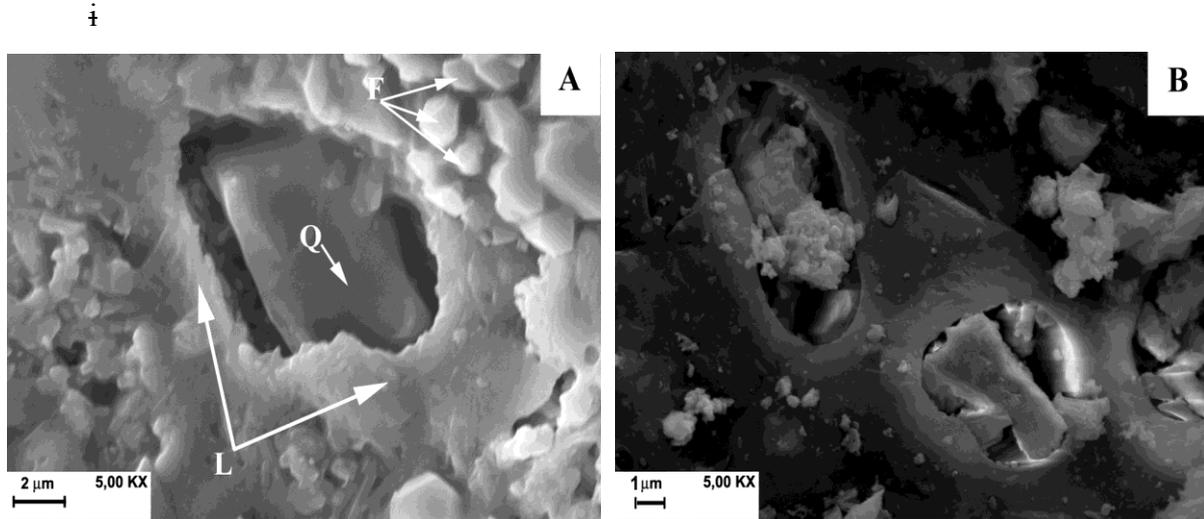
**Figure I-18** : Micrographies de MEB d'agrégats AK-BO cuits à 1100°C.
