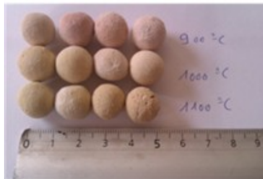
Figure I-7 : Agrégats de mélanges BO-AG.
