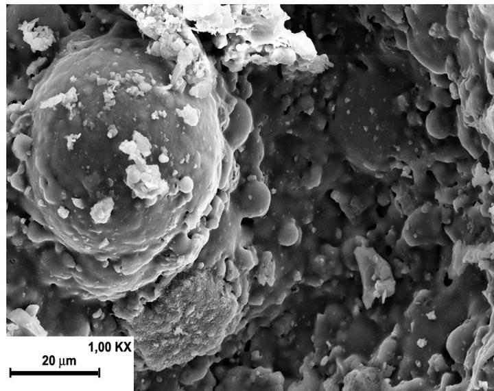
*Figure II-32 : Micrographies de MEB d'agrégats de mélange ternaire CV-AK-BO cuit à 1100°C montrant la formation de phase vitreuse.*
