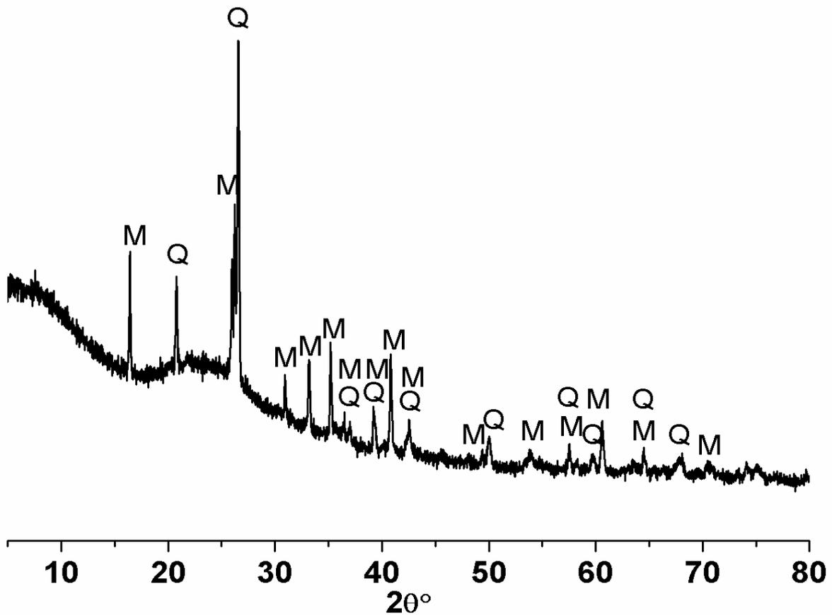
Figure I-6 : Diffractogrammes des rayons X de CV.
