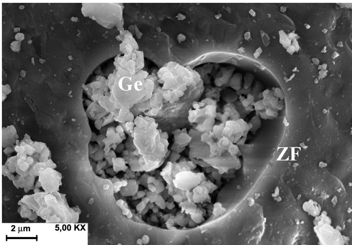
*Figure II-8 : Micrographie de MEB d'agréats contenant 30 % masse de AG.
