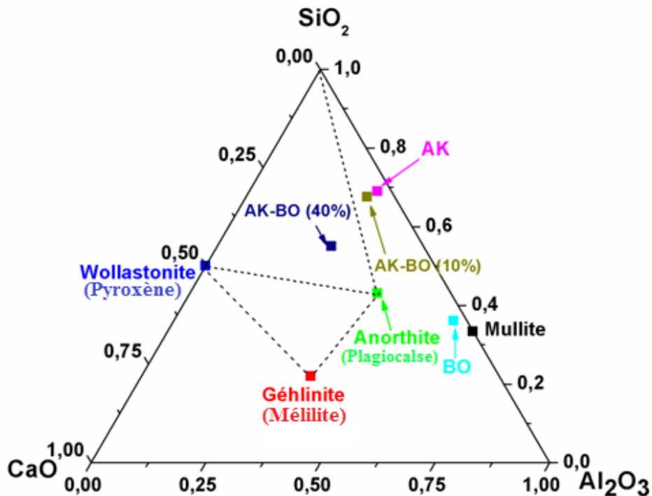
*Figure II-19 : Diagramme de phases CaO-SiO<sub>2</sub>-Al<sub>2</sub>O<sub>3</sub> montrant les points représentatifs des échantillons étudiés dans le cas du mélange AK-BO.*
