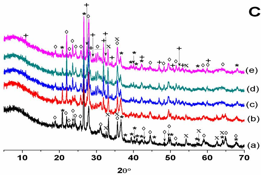
**Figure II-15 :** Diffractogrammes des rayons X d'agrégats
