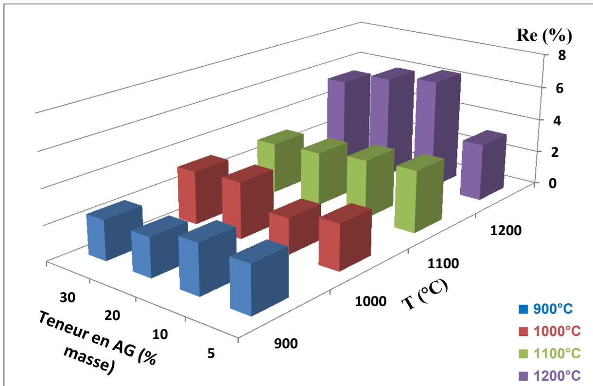
Figure II-11 : Variation du retrait à la cuisson des agrégats avec la température et la quantité ajoutée en argile.
