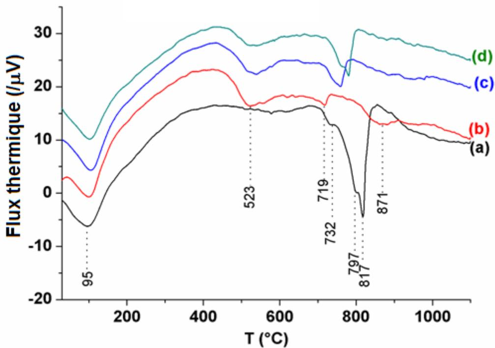
*Figure II-17 : Courbes d'analyse thermique différentielle de BO, de AK et de mélange BO-AK à 20% et 40% masse de BO.
