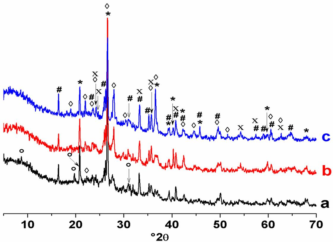
*Figure II-28 : Diffractogrammes des rayons X des agrégats du mélange 65,5%CV-43%AK-BO cuits à (a) 900 (b) 1000 et (c) 1100°C.
