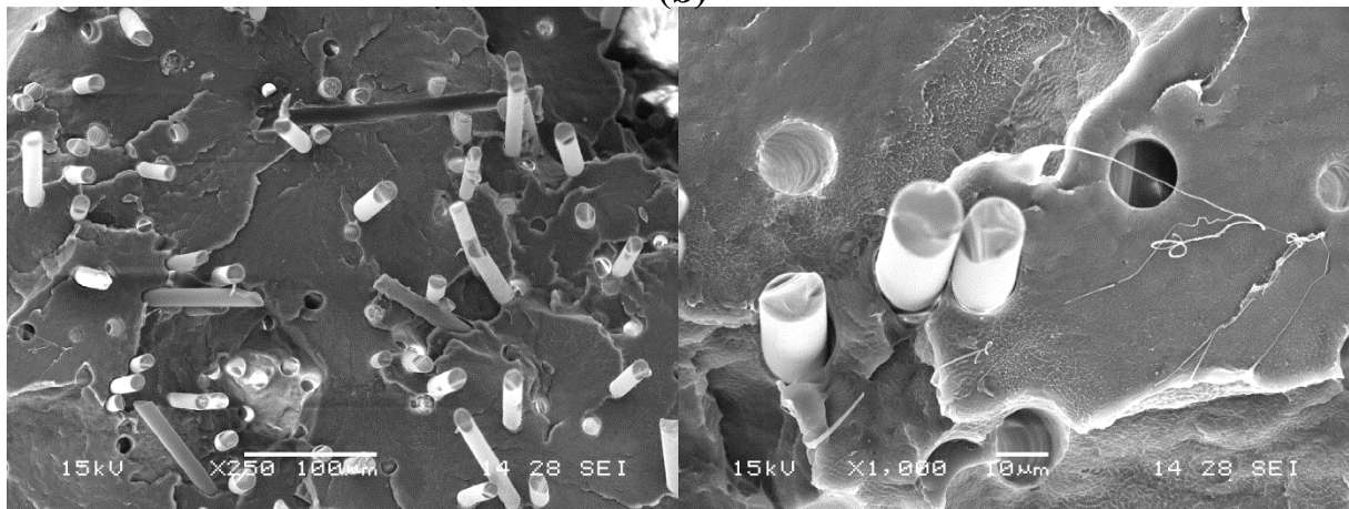
Figure 27 Clichés MEB à différents grossissements de la zone de fracture des composites : a) 100% LDPE, b) 20% FC-LDPE et c) 20% FV-LDPE
