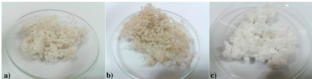
Figure 26 Photos de : a) Filaments de cellulose 30% b) Filaments de cellulose après séchage direct c) Filaments de cellulose traités par NaCl après séchage
