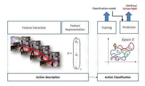
FIGURE 1: Schéma d'un système de reconnaissance d'actions
