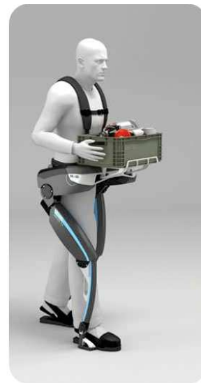
FIGURE 1.10 – L'exosquelette pneumatique Muscle Suit
