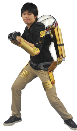
FIGURE 1.10 – L'exosquelette pneumatique Muscle Suit
