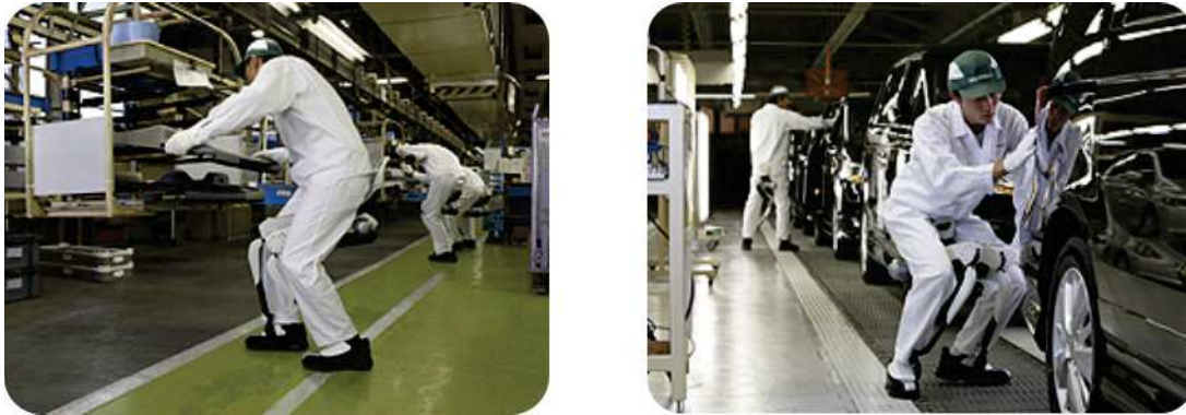
FIGURE 1.9 – Le BSA utilisé pour l'assistance des opérateurs de l'usine Honda [Honda, 2013]
