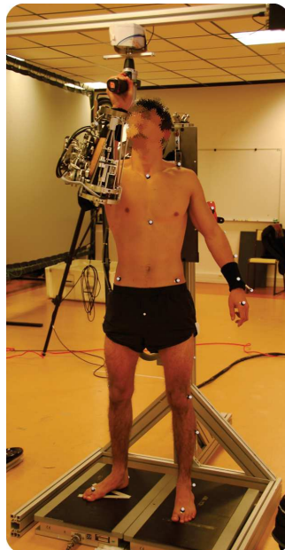
FIGURE 4.1 – Capture du mouvement assisté par l'exosquelette
