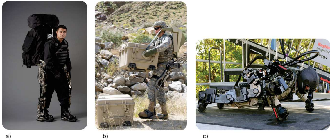
FIGURE 1.6 – Les exosquelettes développés pour le programme de la DARPA : BLEEX (a), HULC (b) et XOS (c)
