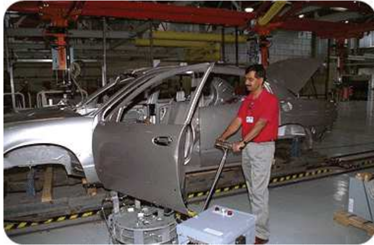
FIGURE 1.3 – Cobot dédié à l’assistance au démontage de portes dans les usines General Motors [Peshkin et al. , 2001]
