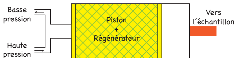
FIGURE II.6 – Schéma d'un réfrigérateur de type Gifford-McMahon.
