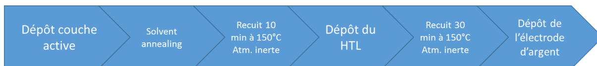
Figure n° III-7: Procédé de fabrication d'une cellule simple à base de HBG2 depuis le dépôt de la couche active
