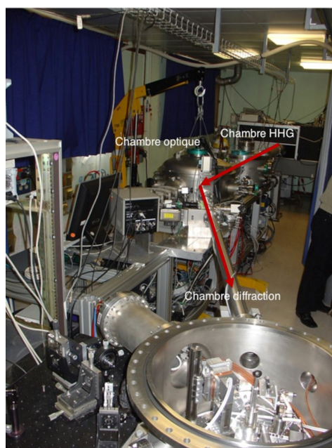
Figure 3.3 Photo des 3 enceintes La flèche rouge indique le sens de propagation du faisceau. L'ensemble fait environ 5m de long.
