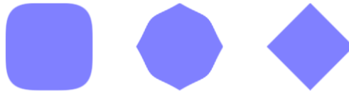
FIGURE 6.3 – Processus d'animation des formes par interpolation de distance field. L'animation permet de passer d'une forme en squircle (courbe de Lamé d'ordre 4) à un diamant. L'image centrale montre l'état à moitié de l'animation.
