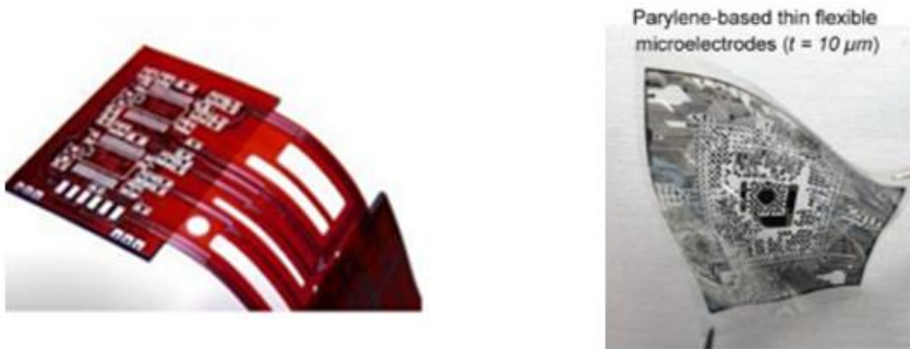
Figure I. 10 a) Câble Flexible PCB [ www.paryleneconformalcoating.com ], b) microélectrode imprimée sur des films de parylène [Kim 17]
