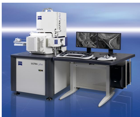
Figure II. 4 Microscopie électronique par effet de champ (FESEM) Zeiss ultra plus (Carl Zeiss SMT-Nano Technology System Division)
